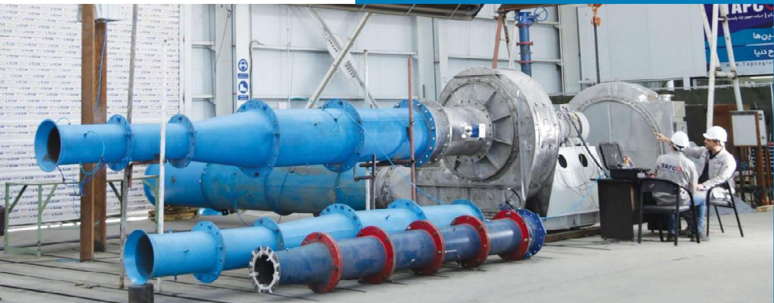
تست‌های عملکردی محصولات تاپکو، مطابق با استاندارد ASME/10 PTC و ANSI/AMCA 210 استاندارد ASME PTC10 در کارخانه تاپکو انجام می‌شود. ظرفیت توان تست مدار تست تاپکو ۱۲ مگاوات می‌باشد. این تست‌ها می‌توانند در شرایط مشابه و بادور یابین‌تر، دور اصلی و توان مصرفی کمتر و حتی با توان مصرفی اصلی و با توجه به تجهیز و شرایط فرآیندی و گاز انتقالی انجام شوند. در این حالت می‌توان از راهنمایی‌های استاندارد AMCA802 برای فن و استاندارد ASME PTC10 برای کمپرسورها استفاده کرد.
